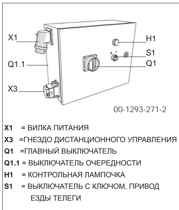
Рисунок 4.31. Электрошкаф телеги
