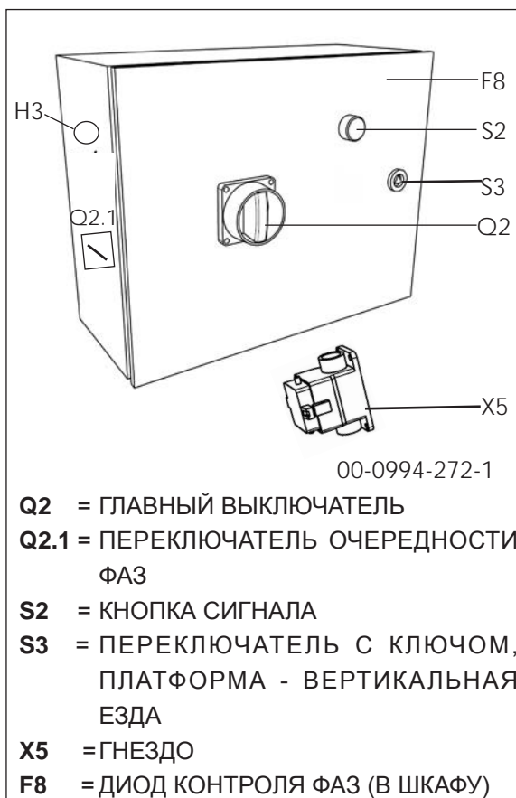
Рисунок 4.16. Электрошкаф платформы
